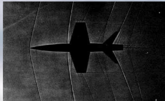
Фронты ударных волн при обтекании сверхзвуковым потоком модели самолета
