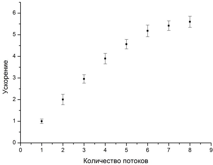
Рис. 6: Зависимость ускорения от количества потоков ( $t=200(\text{с})$ )
