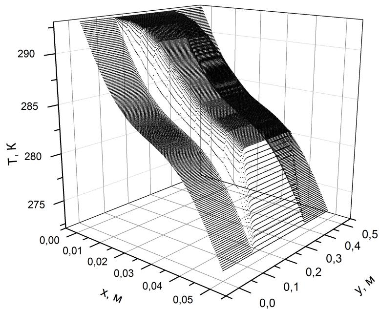
Рис. 2: Распределение температуры в установленном режиме при  $z = 0.3(\text{м})$  ( $t = 500(\text{с})$ )
