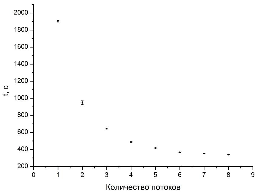
Рис. 5: Зависимость времени выполнения программы от количества потоков ( $t = 200(\text{с})$ )
