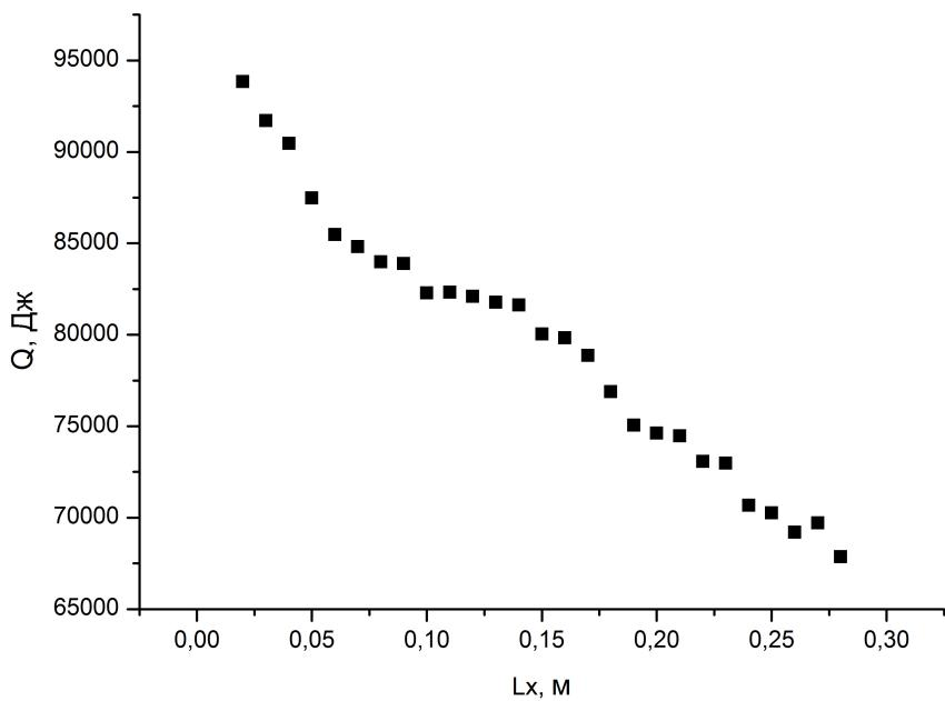
Рис. 4: Зависимость ушедшего количества теплоты от  $L$  ( $t = 200(\text{с})$ )
