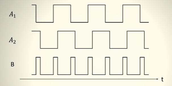
Мы получаем вспомогательный сигнал  $B(t)=A_1(t)xorA_2(t)$ . Заметим, что сигнал B(t)=1 в течении времени равного двум разностям фаз за период. Т.е.  $\Delta \varphi = \frac{n(B(t)=1)}{2 \cdot T}$
