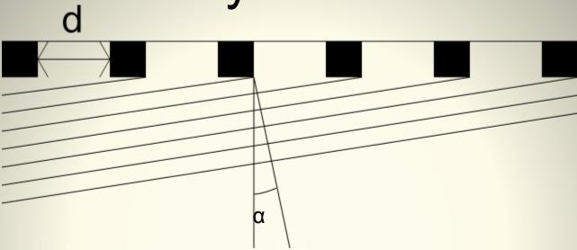
Для простоты математической обработки будем работать в плоских волнах, т.е. излучатель будет состоять из ряда одинаковых излучателей сферических волн со строго определенным сдвигом фаз между соседними источниками.
